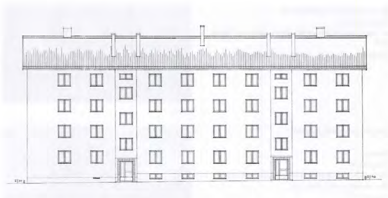
Fasadritning till Handelsmansgatan 8A och 8B i kv. Daggmasken från 1947 av arkitekten Filip Lundgren. Fasaden var från början putsad, men har senare kläts in med tegel. Original i Helsingborgs stadsarkiv.
