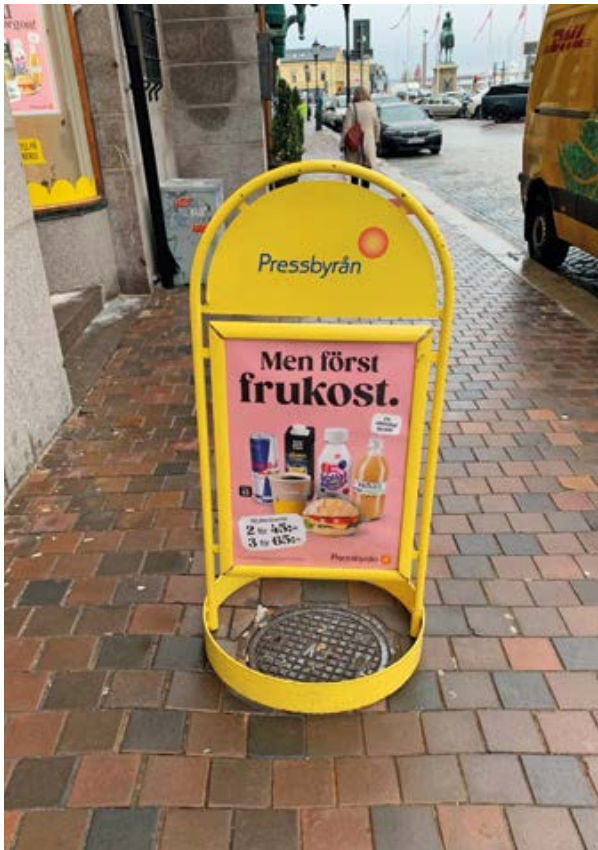
Gatupratere med rund fot som är enkel att upptäcka för dem som tar sig fram med orienteringskäpp.
