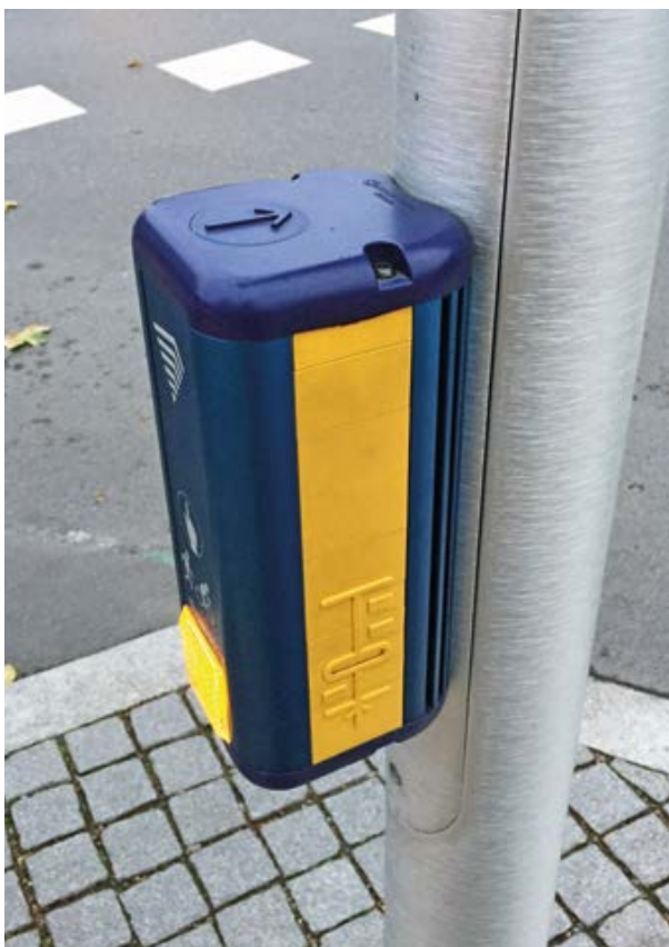
Tryckbox med taktil karta som visar riktning över gatan vid signalreglerat övergångsställe.
