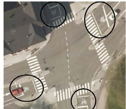
Cykelboxar i korsningen Trädgårdsgatan, Södergatan och Södra Storgatan.
