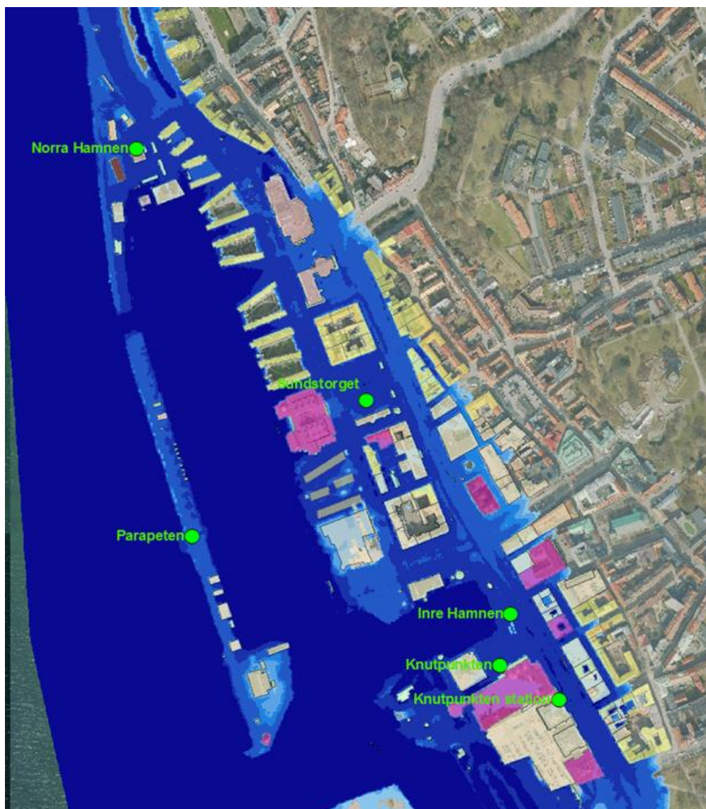
Figur 10 Avloppspumpstationer i utredningsområdet med extremvattensituationen +350 cm.
