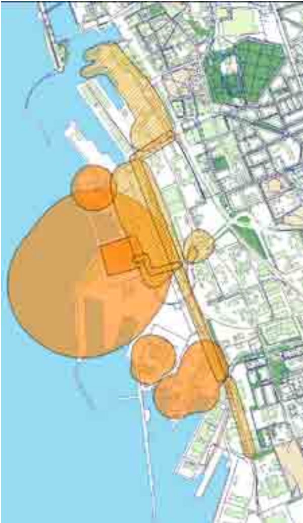
Bild nr.113 Sammanställning av uppmärksambetsavstånd avseende risk för verksamheter i anslutning till H+ området. Pelletsladan, Oljehamnen, Öresundsverkets gasolcistern och Västhamnsverket är angivna som konsekvensavstånd. Övriga uppmärksambetsavstånd är angivna utifrån individriskenivå.
