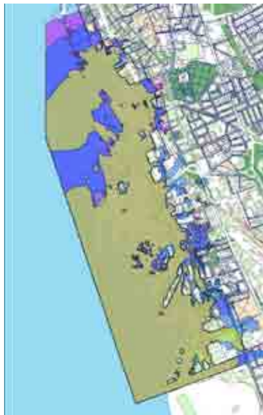
Bild nr.114 Figur visar hamnens samlade ljudutbredning på 1,5 m ovan mark. Gul färg = dag ekv 60 dBA, blå = kväll ekv 55 dBA, lila = natt ekv 50 dBA.
