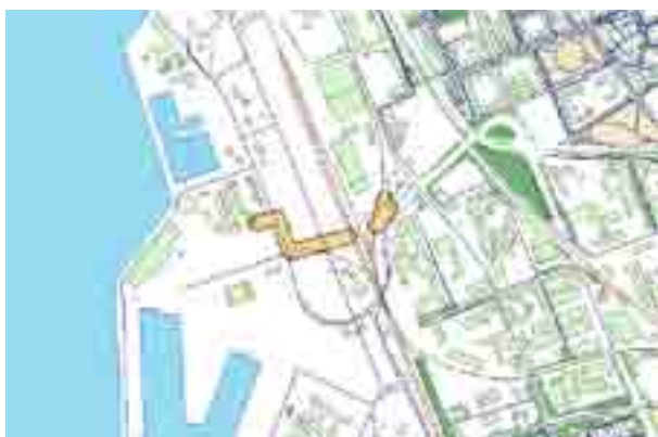
Bild nr.112 Uppmärksamhetsavstånd från fjärrvärmeledning ovan mark angivet som individriskavstånd, ca 17m från lednings mitt.
