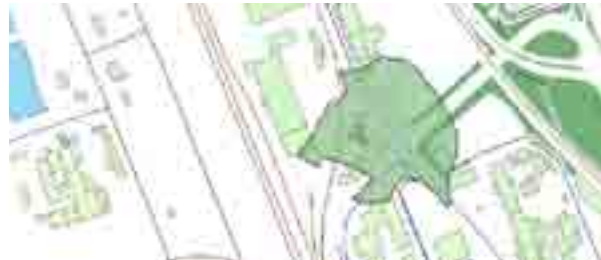
Bild nr.118 Ljudutbredning (ekv 40 dBA) för kraftvärmeverk Israel med normal drift enbart pumpstation.
