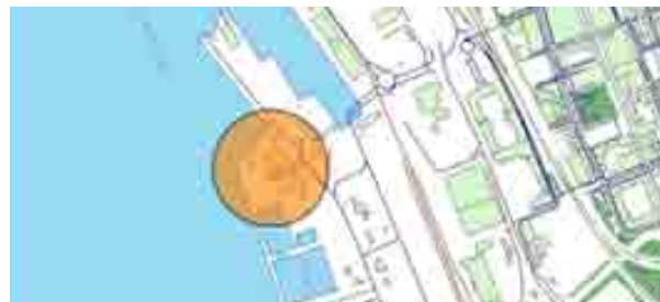
Bild nr. 107 Uppmärksamhetsavstånd utifrån identifierade riskkällor inom Öresundsverket, 120 m från gasolcistern. Avstånd angivet som konsekvensavstånd.
