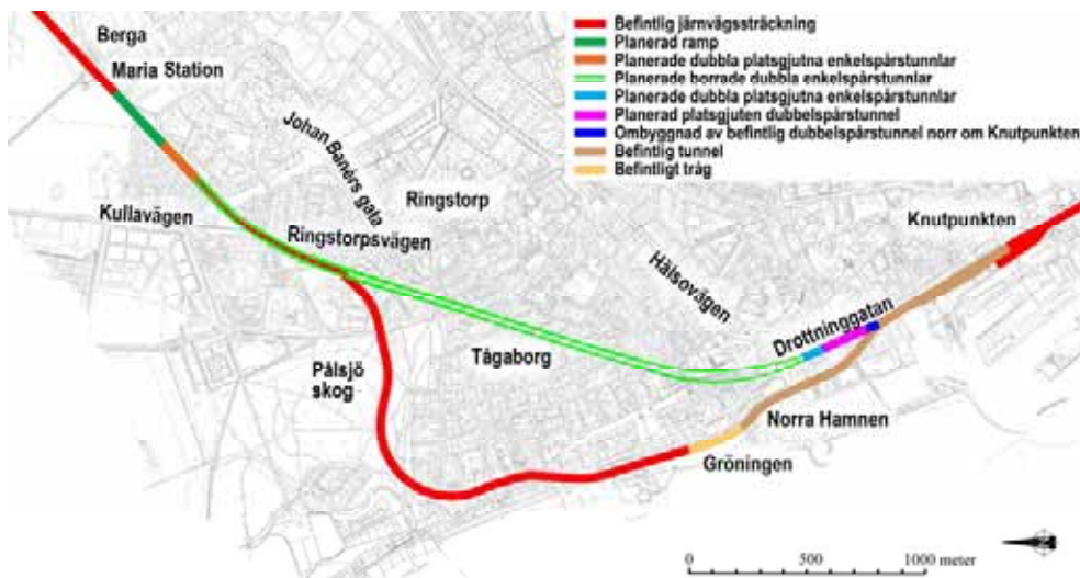
Figur 4.5 Anläggningsdelar för Norra Tunneln
