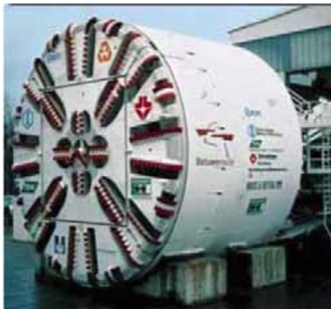
Figur 4.11 Tunnelbormaskin med borrhuvud och bakomliggande sköld.
