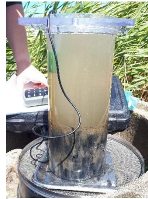
Figur 12: Provtagning av redoxpotential med en Haps-core cylinder.
