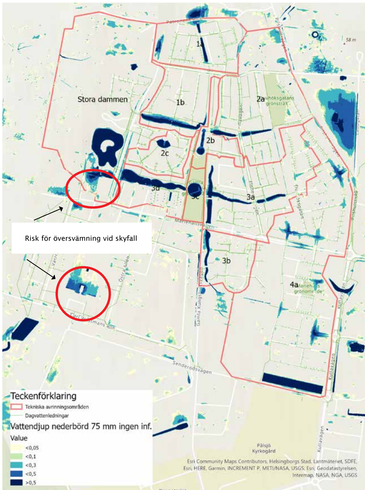
54. Illustration översvämningsdjup inom Mariastaden vid 75 mm nederbörd och utan hänsyn till infiltration och avledning via ledningsnät.
