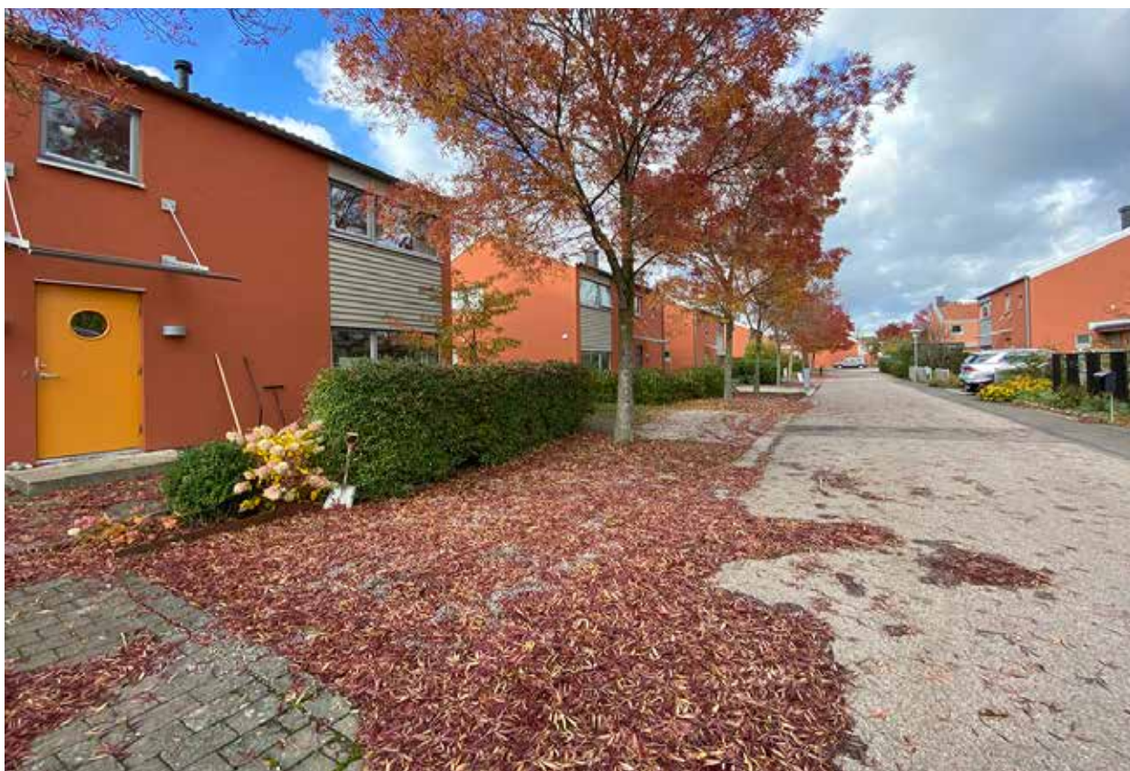
86. Foto Utanför bostad den 22 oktober 2021 i Örtagårdens bostadsområde. Dygnet innan hade det regnat 23 mm. Asklöven visar tydligt var det har stått vatten tidigare den dagen.
