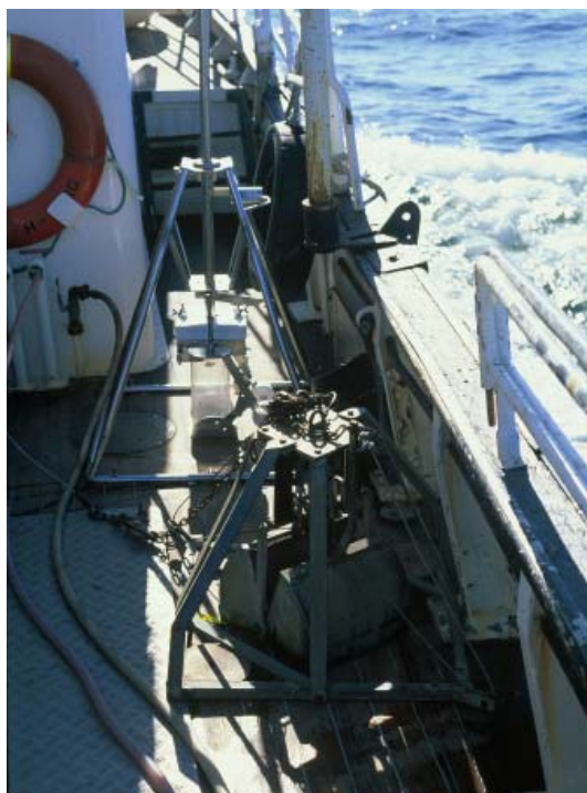
Traditionellt brukar provtagning av bottenfauna utföras med bottenhuggare (vänstra bilden i förgrunden Aberdeen-huggare) längs svenska kusten. Den danska Haps-coreren (till höger) tar mindre bottenyta men djupare i sedimentet och är bättre att använda för sedimentundersökningar. Prover tagna med Haps-corer är också lättare att bearbeta än prover som tagits med huggare.
