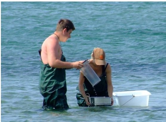
Figur 8. Infaunaprovtagning med Hapscorercylinder.
