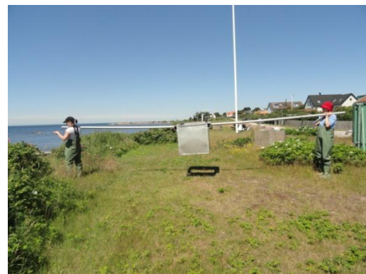
Figur 3. Fallfällan som användes vid provtagning av mobil epibentiska fauna.
