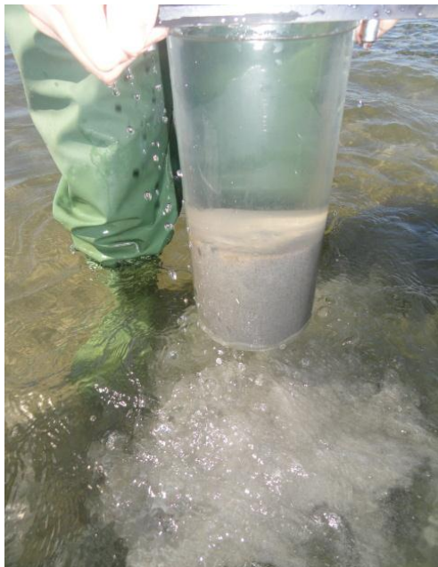
Figur 2. Provtagning av infaunan togs med en Hapscorer-cylinder.
