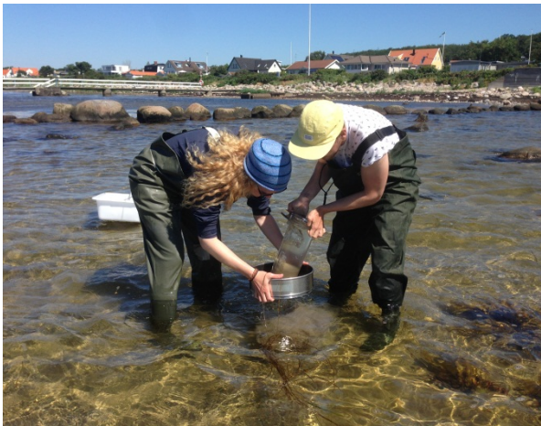
Figur 2: Provtagning av infauna med Haps-core cylinder. Vä: Haps-corer med sedimentprov som öppnas över ett såll. Hö: insamling av fauna från sållresten.
