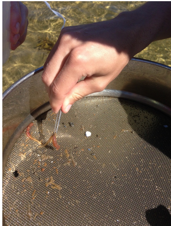
Figur 2: Provtagning av infauna med Haps-core cylinder. Vä: Haps-corer med sedimentprov som öppnas över ett såll. Hö: insamling av fauna från sållresten.
