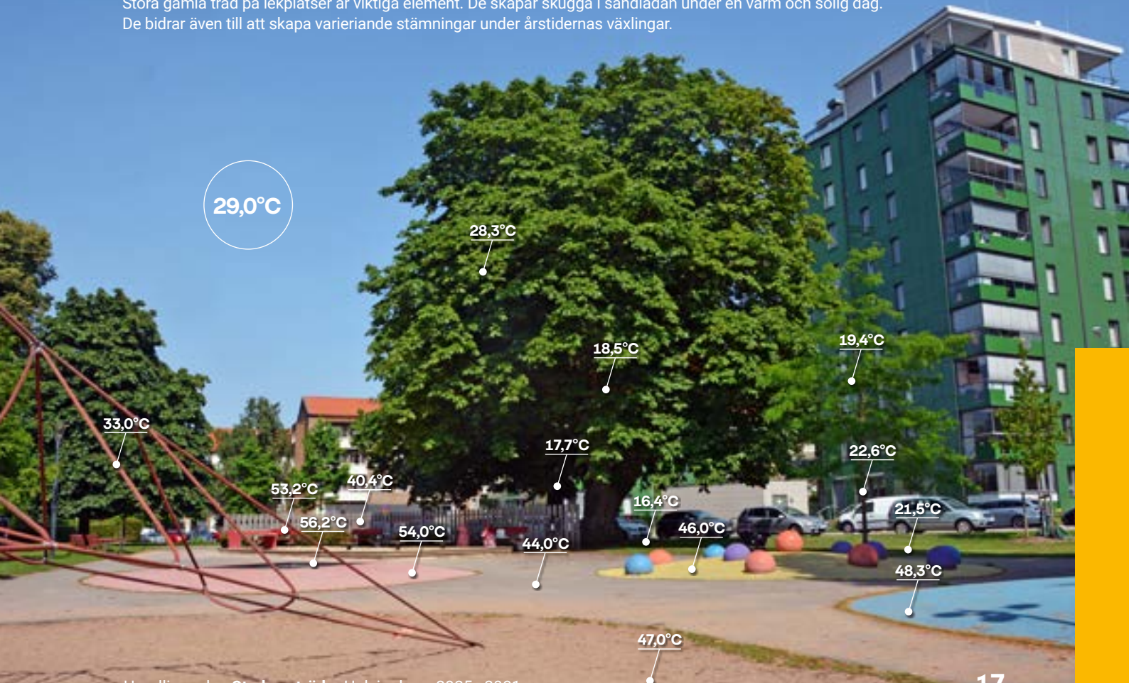
När det kommer till ytemperaturer kan ytor som skuggas av gatuträd vara tiotals grader lägre än närliggande solbelysta ytor. Temperaturerna i bilden är uppmätta med infraröd termometer i juli 2021.
