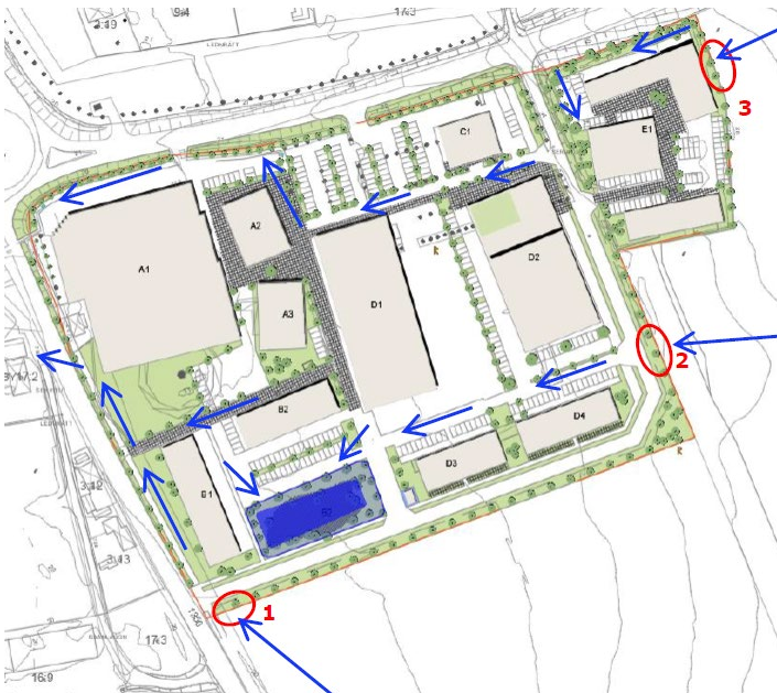
Schematisk översiktsbild av skyfallsprincipen för området. Röda inringningar representerar inkommande rinnvägar till planområdet, och blåa pilar markerar rinnriktning för skyfallsstråk. Höjdsättning av nya områden ska ske så att marken lutar mot de föreslagna skyfallsstråken. Bild: Ramboll.
