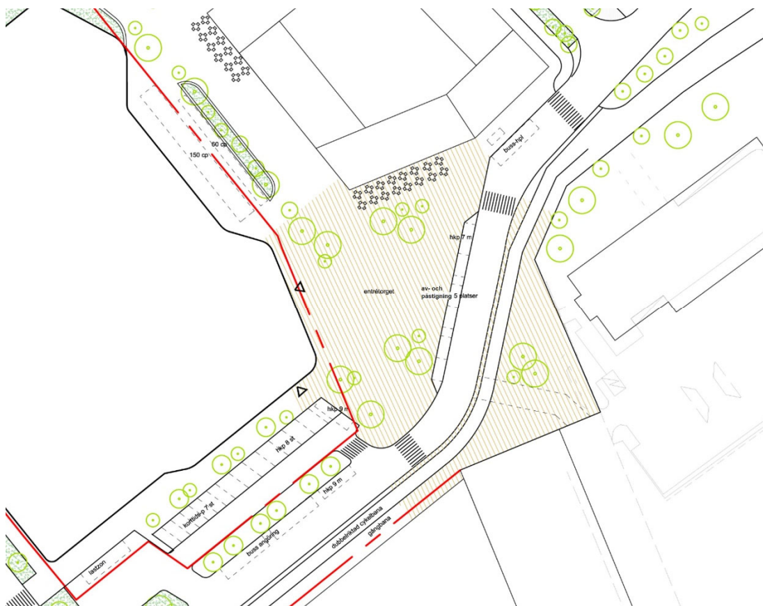
2.12 Entrétorget och ankoringsplatsen utanför badhuset. I stråket norrut syns en nedsänkt växtbädd för skyfallshantering.
