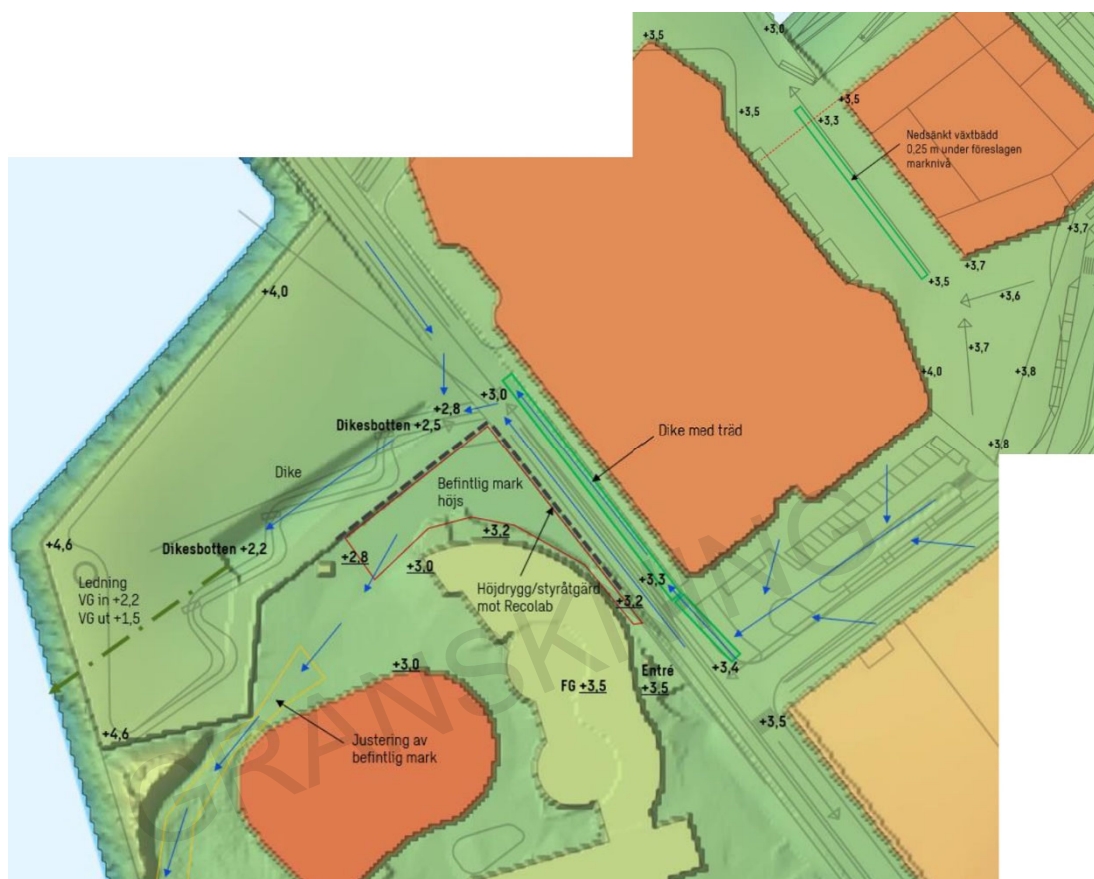
3.7 Höjdsättning utifrån vattenavrinning samt skyfallsåtgärder. (Sweco)
