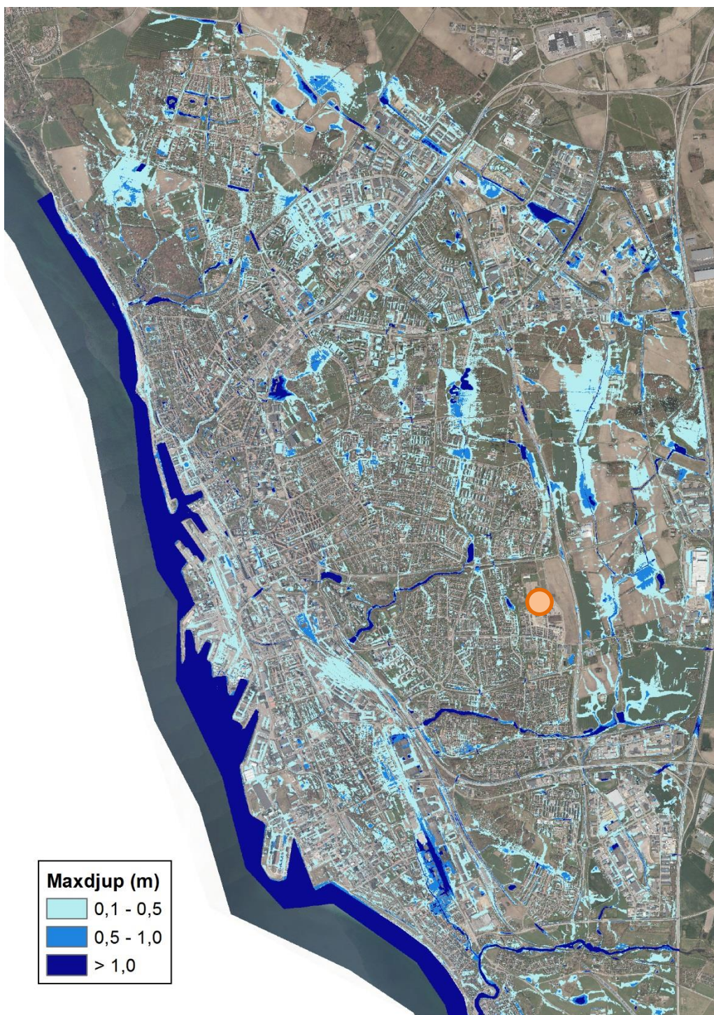
Figur 14 Resultat från modellering av ett 100-årsregn år 2065. Endast områden med vattendjup större än 1 dm visas.
