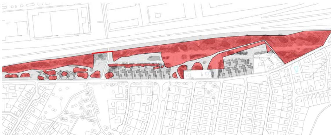
Illustration av befintlig grönskas kontur ovan planförslaget med den föreslagna bullerskärmen markerad.
