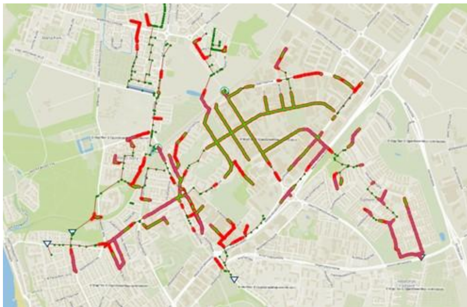
Figur 21. Markuppdämning vid olika regnbelastningar, utan åtgärder
