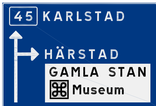
Figur 1-22 Orienteringstavla med infälld grön platta för vägvisning till mål som nås via motortrafikled
