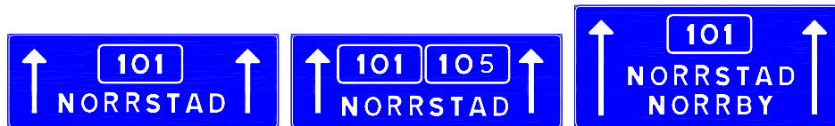
Figur 2-37 Grundformer för körfältsvägvisare, 2-fältiga utföranden
