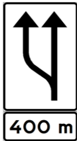
Figur 2-6 Förberedande upplysning om tillkommande körfält till vänster. Mötande trafik är avskiljd med mittremsa, räcke eller annan fysisk anordning.
