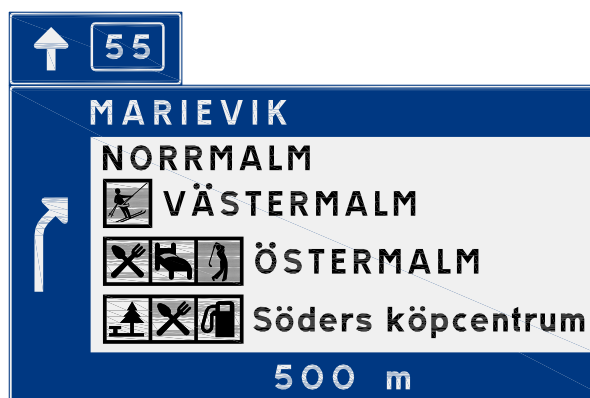
Figur 1-27 Aufartsorienteringstavla med infälld vit platta för vägvisning till lokala mål och inrättningar
