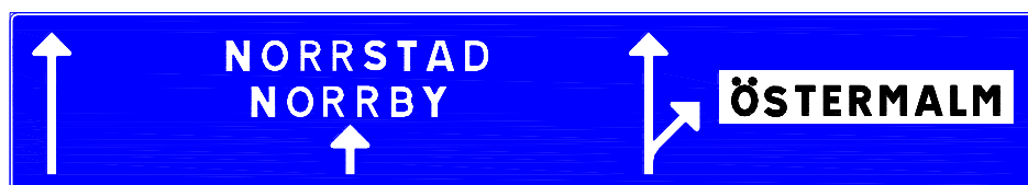
Figur 2-41 Varianter med kombinationspilar för körfältsvägvisare, 3-fältigt utförande
