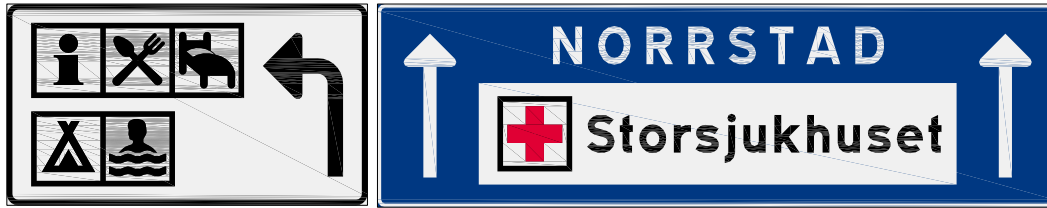
Figur 1-34 Körfältsvägvisare med platta för vägvisning till sjukhus med akutmottagning och med vägvisning till ett antal serviceanläggningar
