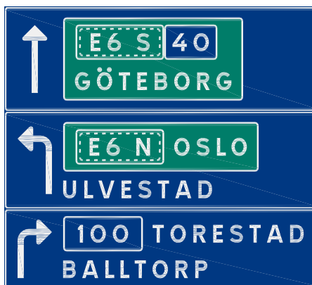
Figur 1-26 Tabellvägvisare med infällda gröna plattor för vägvisning till motorväg eller motortrafikled
