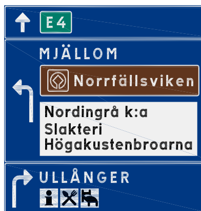
Figur 1-29 Tabellvägvisare med brun platta för vägvisning till världsarv och vita plattor för vägvisning till inrättningar och serviceanläggningar
