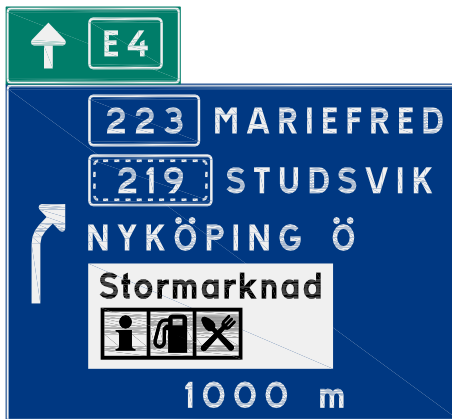
Figur 1-30 Aufartsorienteringstavla med infälld platta för vägvisning till inrättning där även serviceanläggningar finns
