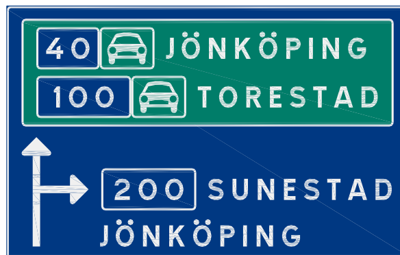
Figur 1-23 Orienteringstavla med infälld grön platta för vägvisning till mål som nås via motortrafikled
