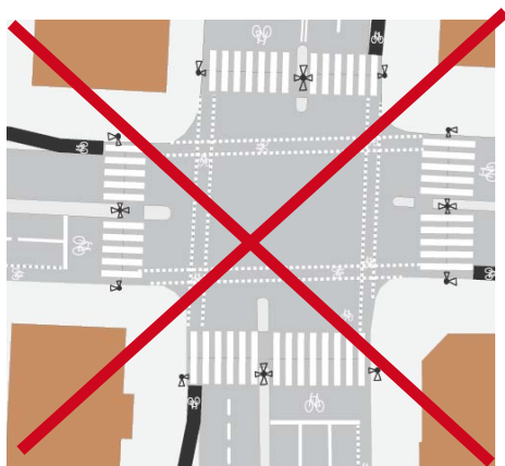
Bild 8 Signalreglerad korsning. Cykelfält är felaktigt markerade genom korsningen.
