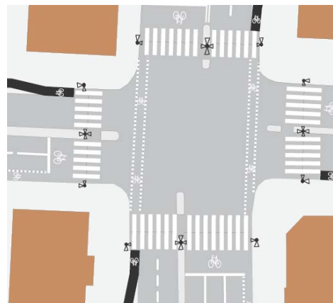
Bild 9 Signalreglerad korsning. Cykelfälten för det största stråket är korrekt markerat genom korsningen.
