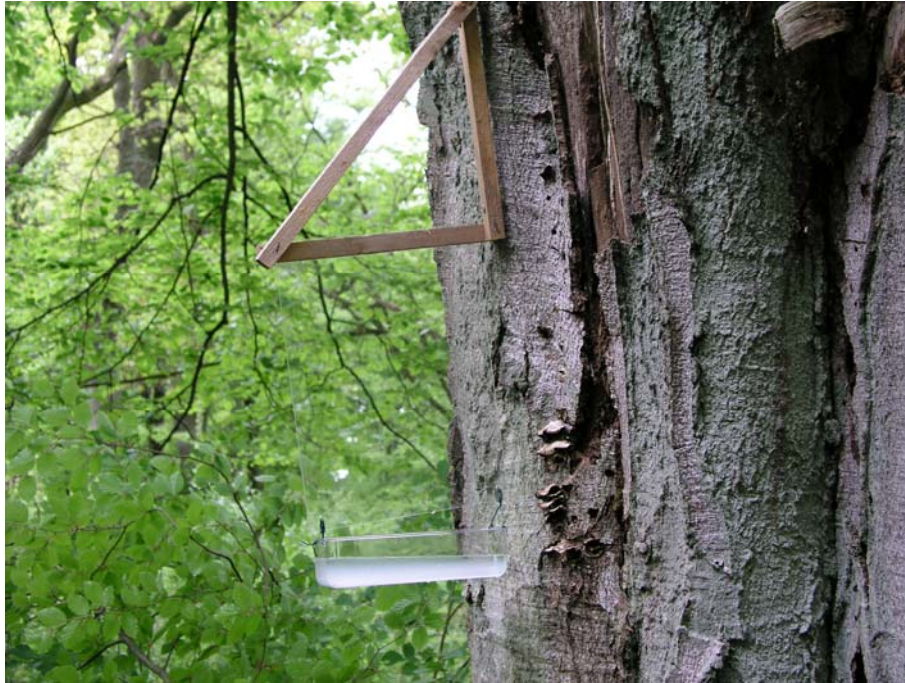
Figur 2. Fönsterfälla monteras på trädet via en träställning. Under det genomskinliga plexiglasets hänger en behållaren med vatten, salt och några droppar diskmedel för att minska ytspänningen.
