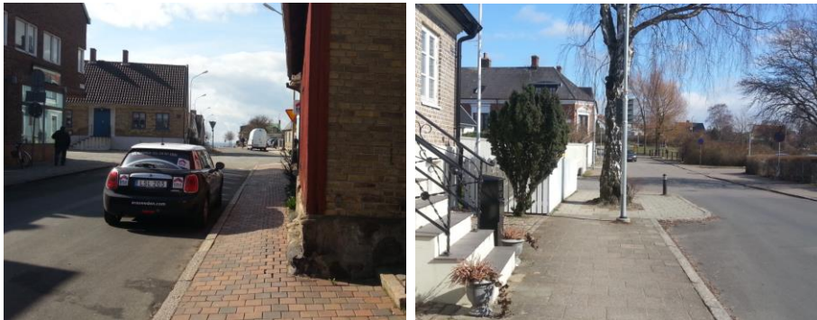
Figur 8 Exempel på smala sektioner idag. Belysningsstolpen i högra bilden begränsar utrymmet för gående ytterligare.
