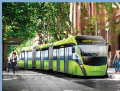
Figur 10. Malmöexpressen. I Malmö utmynnade fordonskonceptet i en dubbelledad buss från Van Hool med gas och elhybridsdrift.
